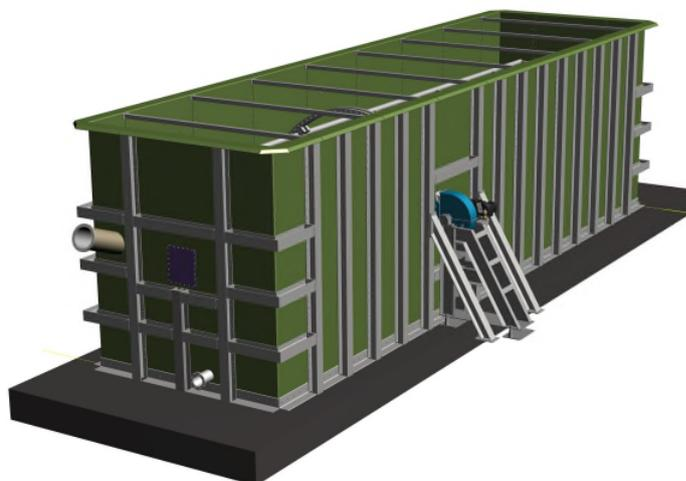
Das patentierte Rührwerk mit einem aus dem Bergbau adaptierten Triebbradtrieb gewährleistet einen kontinuierlichen Pfropfenstrom und fördert das Substrat betriebssicher durch den Fermenter.
